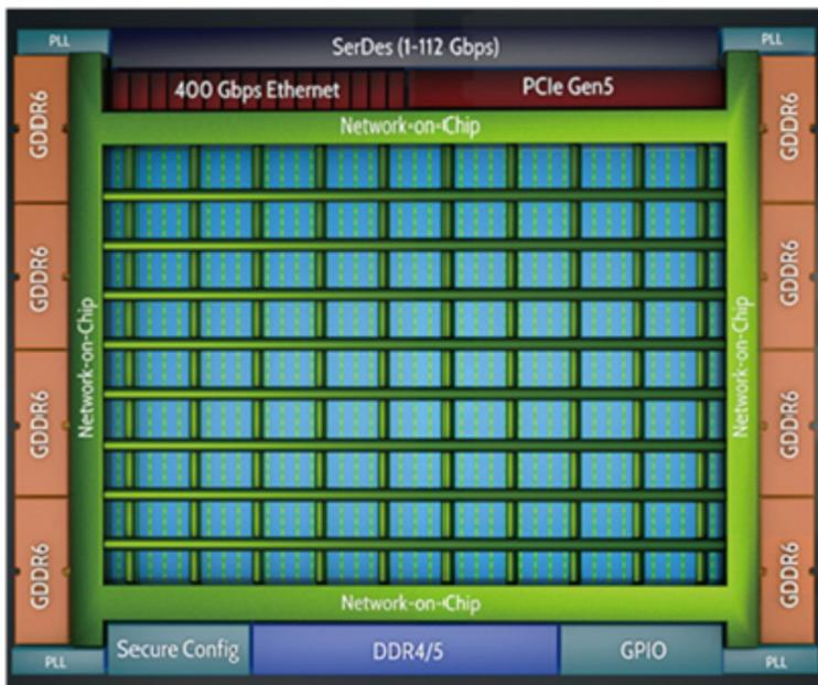
图 5: Achronix Speedster7t1500 高性能 FPGA 架构
