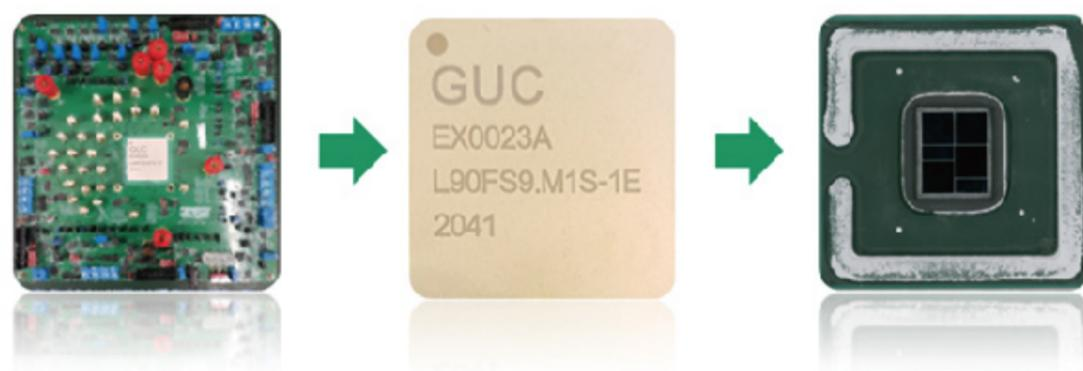
Figure-3 GUC GLink 接口 IP 评估板和 InFO\_oS 工程样片
